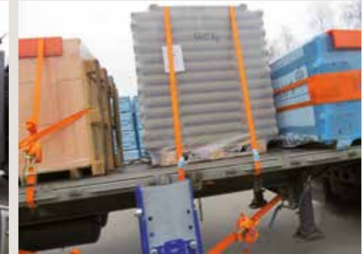
Mischladung: teilweise ohne Formschluss
