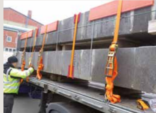
Schornsteinstapel in Fahrtrichtung vorn
