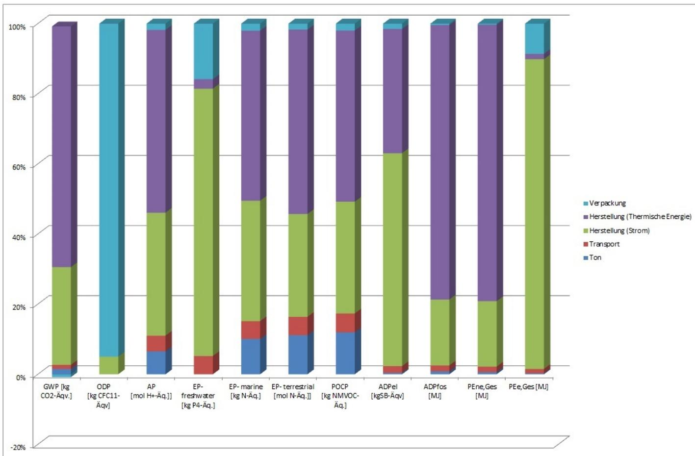
Die Auswertung der ökobilanziellen Ergebnisse der Dachziegel zeigt auf, dass die Umweltwirkungen in allen Umweltkategorien speziell vom Energieverbrauch während des Herstellungsprozesses (Strom und thermische Energie aus Erdgas) im Werk dominiert werden.
