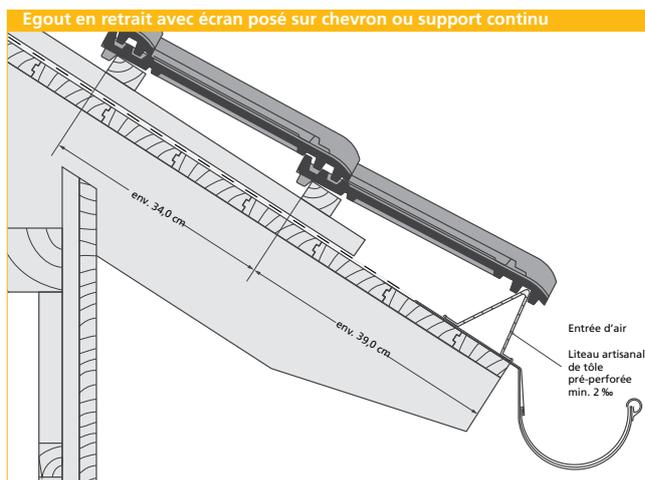
Les schémas CAD sont à l'échelle 1:10 pour les représentations de cette page. Nous recommandons la mise en place d'une bande d'égout.
