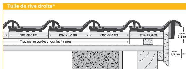
\* Dans le cas de faible pente, prévoir une fixation étanche au niveau des trous de clouage de la tuile de rive.
