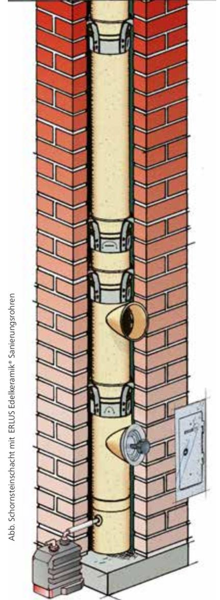
Abb. Schornsteinschacht mit ERLUS Edelkeramik® Sanierungsrohren
