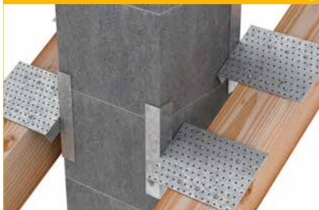
Bestehend aus Haltewinkel und Nagelplatte (sind über eine Achse drehbar miteinander verbunden). Die Sparrenhalter werden direkt auf den Sparren genagelt und ergeben sofort seitlichen Halt. Der Sparrenhalter ist sowohl für Neubau als auch zum nachträglichen Einbau geeignet.
