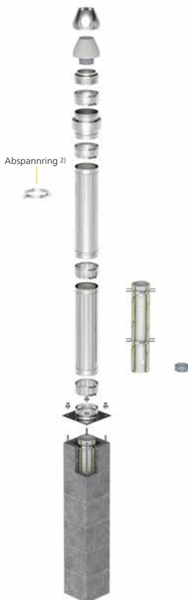
Aufbauschema Wechsel im Dach
