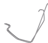
Universal ERLUS Sturmklammer II, Größen M oder XL aus 2,2 mm federhartem Edelstahl
