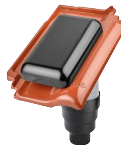
ALU-SYSTEM Sanitär-PV-Flachlüfter DN 125 2) mit flacher schwarzer Haube 1) zum Einbau oder Austausch unter Solaranlagen, Anschlusschlauch (70 cm), UD-Manschette und Reduzierstück
