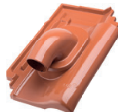
Dachówka przepustowa ALU-SYSTEM dla instalacji fotowoltaicznych z płytą podstawową, Ø ok. 58 mm
