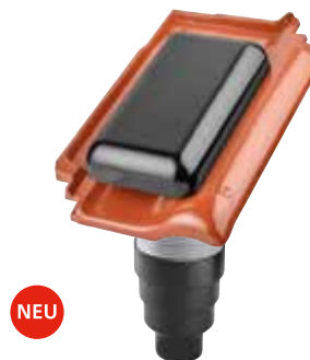
ALU-SYSTEM Sanitär-PV-Flachlüfter DN 125 mit flacher schwarzer Haube 1) zum Einbau oder Austausch unter Solaranlagen, Anschlusschlauch (70 cm), UD-Manschette und Reduzierstück
