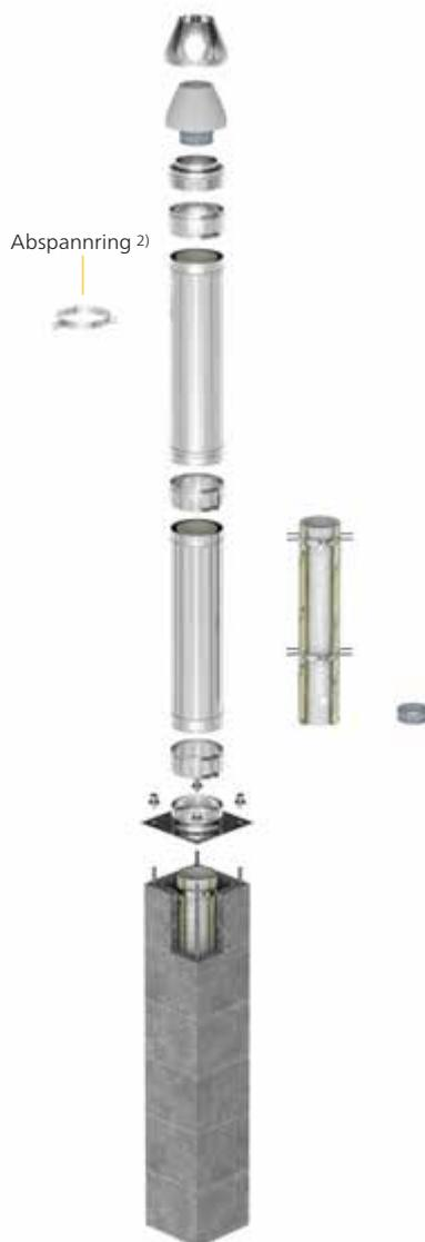
Aufbauschema Wechsel im Dach
