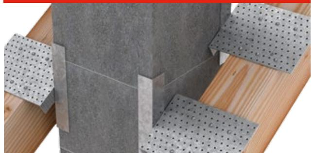
Bestehend aus Haltewinkel und Nagelplatte (sind über eine Achse drehbar miteinander verbunden). Die Sparrenhalter werden direkt auf den Sparren genagelt und geben sofort seitlichen Halt. Der Sparrenhalter ist sowohl für Neubau als auch zum nachträglichen Einbau geeignet.
