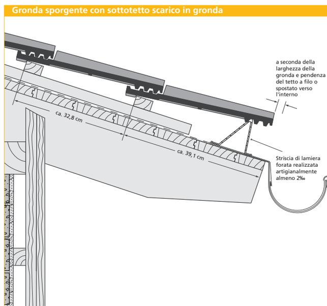
I disegni non sono in scala. I disegni CAD in scala possono essere scaricati dal sito HYPERLINK "http://www.erlus.com". ERLUS consiglia l'impiego di una lamiera per la linea gronda.
