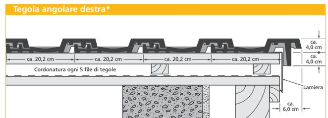
\* Su un tetto piano il foro per il fissaggio delle tegole laterali deve essere sigillato in modo permanentemente elastico (p.es. viti da lattonieri).
