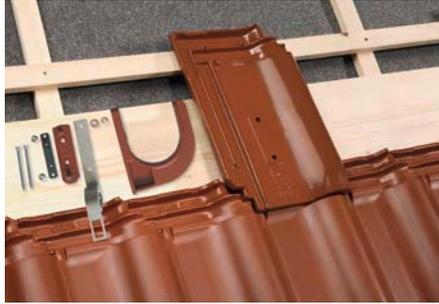
2. Zubehör: Alu-Grundplatte, V2A-Schrauben für Befestigung in Traglatte und Holzbohle (2 x V2A-Schrauben 8/100 zur Verschraubung der Alu-Grundplatte in die Bohle und 2 x V2A-Schrauben 5/60 zur Verschraubung der Alu-Grundplatte in die Dachlatte), Aufnahmeelement, Edelstahlfeder, Dachhaken u. Flachdichtung.
