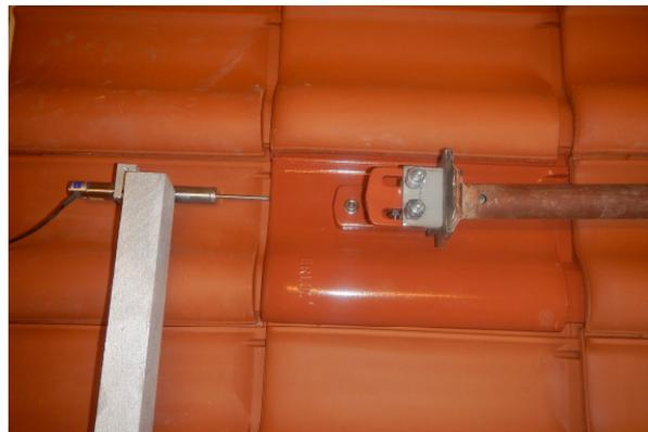
Druckvorrichtung und Wegmessung Richtung First
