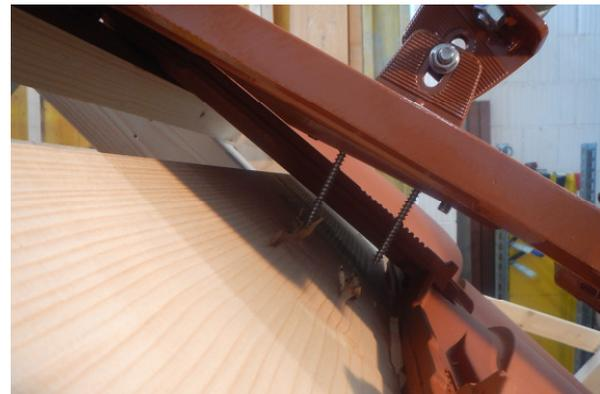
Versagen der Schraubverbindung zur Bohle
