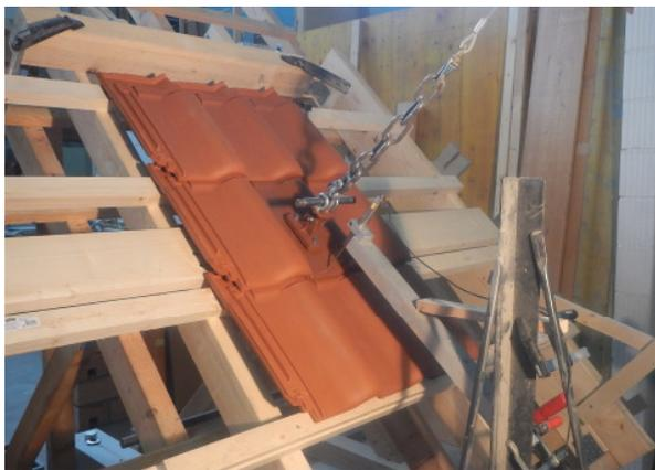
Einrichtung Zuglast senkrecht zur Dachfläche
