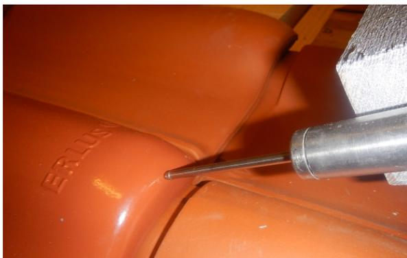
Wegmessung (Verschiebung Dachziegel)
