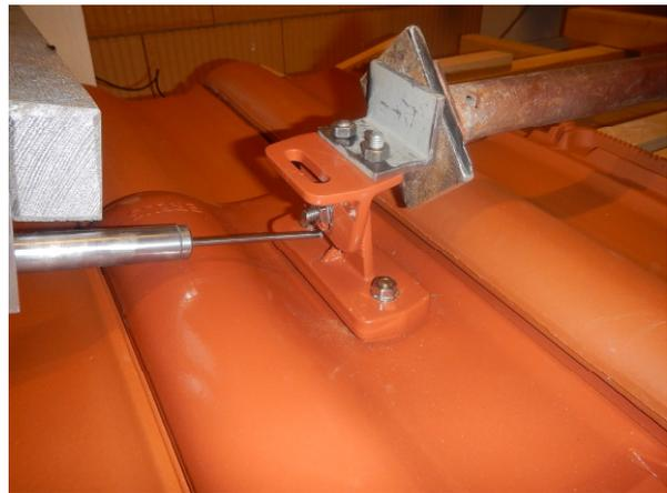
Einrichtung Belastung horizontal Richtung Ortgang / Druckvorrichtung und Wegaufnehmer
