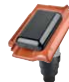
ALU-SYSTEM Sanitär-PV-Flachlüfter DN 125 mit flacher schwarzer Haube 1) 2) zum Einbau oder Austausch unter Solaranlagen, Anschlussschlauch (70 cm), UD-Manschette und Reduzierstück
